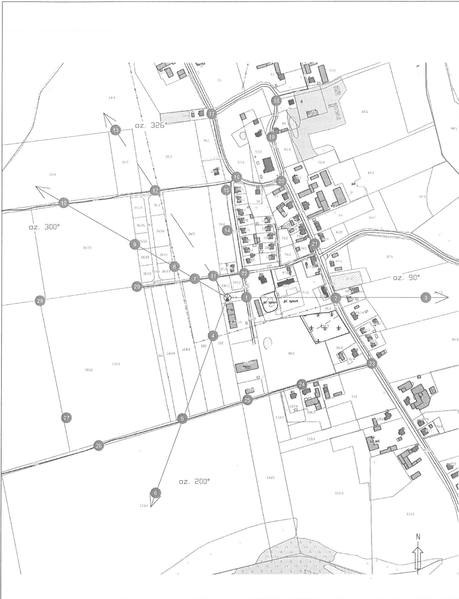
Rys.1 Lokalizacja pionów pomiarowych
